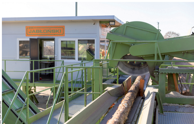
Dzięki wykorzystaniu choćby systemu skanowania 3D, udaje się tak zoptymalizować cięcie surowca, by w pełni go wykorzystywać, bez powstawania zbędnych produktów ubocznych.
